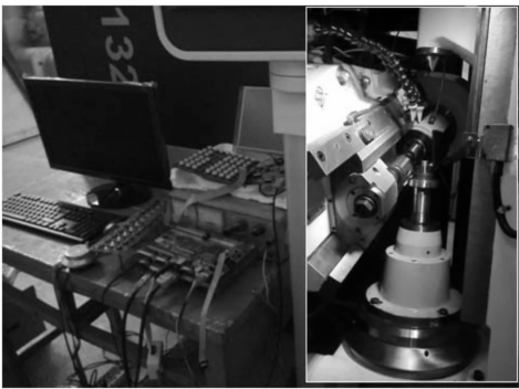
图 10 滚齿机 C 轴转速测试实验台
